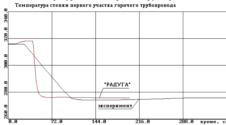
Рис. 5.43. Температура стенки горячего трубопровода 2-ой петли
