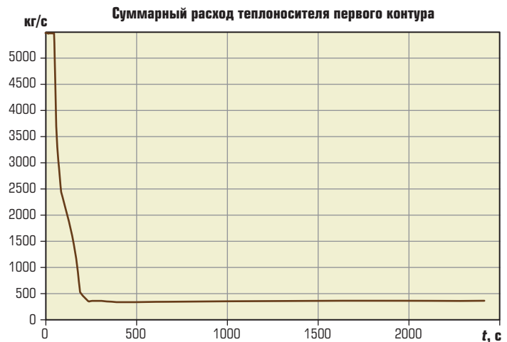
▲ Рис. 12. Изменение расхода теплоносителя первого контура при переходе на СПОТ
