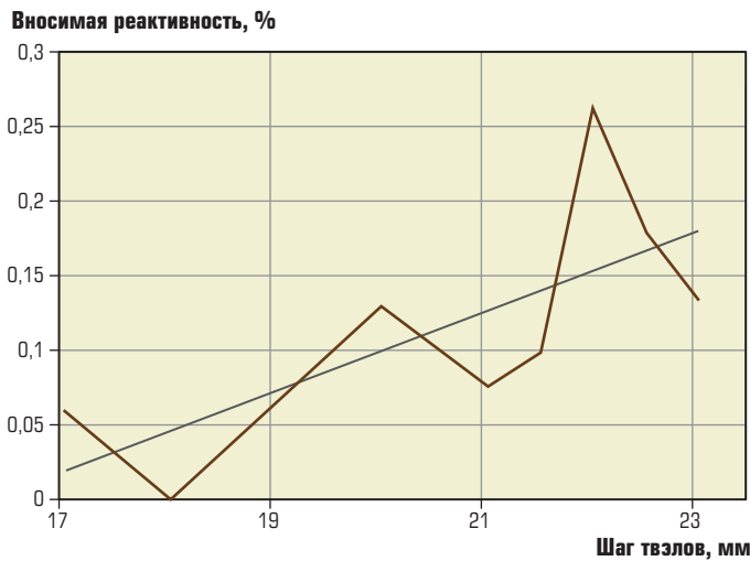
Рис. 10. Вносимая положительная реактивность при мгновенной замене углекислого газа в активной зоне на водяной пар
